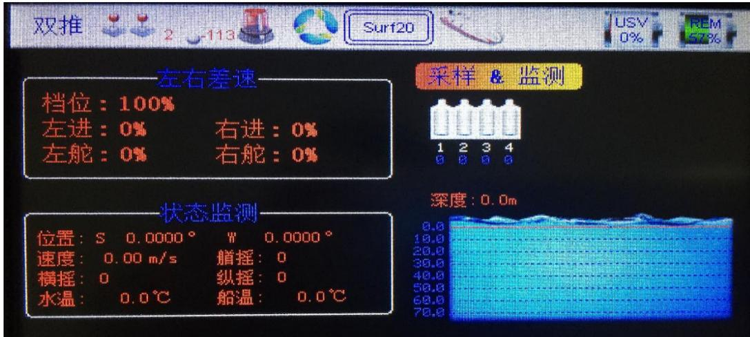
双推双杆模式同样为双摇杆操作，分别使用左右摇杆对船体的推进器进行控制，其中，左摇杆控制左推进器，右摇杆控制右边推进器。其控制方法与单杆操作方法相同。可看到推进模式显示栏显示为“左右差速”，并有“左进”、“左舵”、“右进”、“右舵”的字样。
